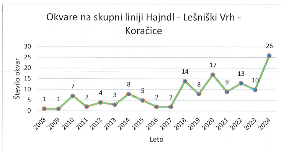
Slika 9: Prikaz okvar na Javnem vodovodnem omrežju na skupni liniji Hajndl – Lešniški vrh – Koračice
